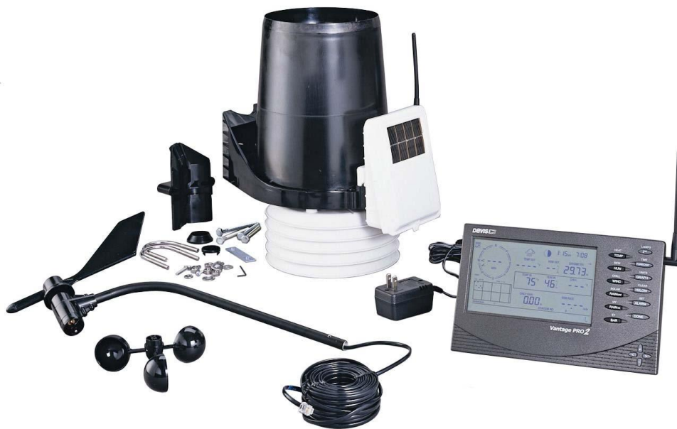
Fonte: DAVIS, 2016. Figura 23 - Estação Meteorológica – Davis
